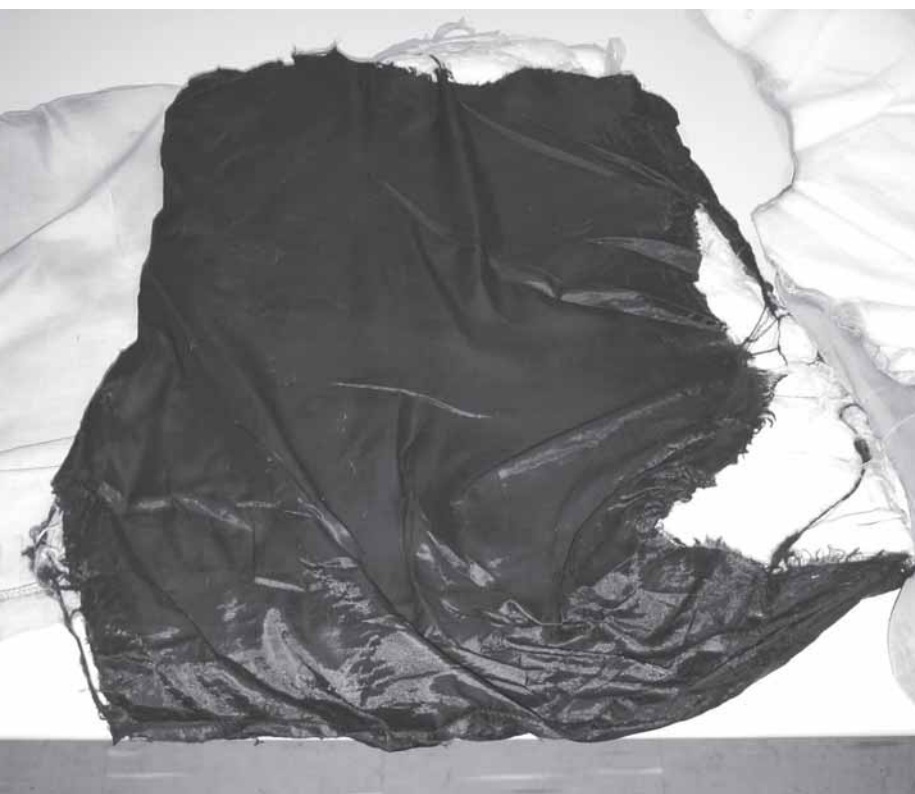
Figura 2 - Colete de proteção sem condições de uso
