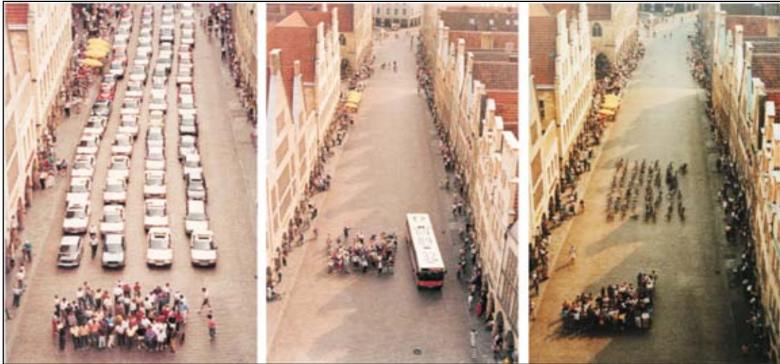
Figura 5 – Espaço necessário para o transporte do mesmo número de pessoas por carros, ônibus ou bicicletas.
