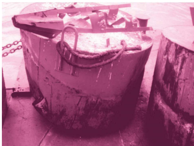
Figura 3 – Bóia danificada no rio São Francisco
